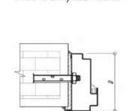
KHUNG LOẠI D/ TYPE D FRAME CỬA MỞ VÀO TRONG PHẠO PHÍA NGOÀI INWARD-OPENING/OUTER-CASING
