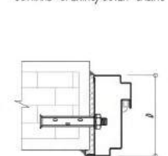
KHUNG LOẠI A/ TYPE A FRAME CỬA MỞ RA NGOÀI PHẠO PHÍA NGOÀI OUTWARD-OPENING/OUTER-CASING
